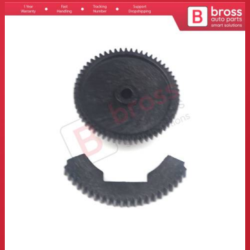
BGE692 Audi VW Seat Skoda Hyundai Kia Mercedes Ford İçin Gaz Kelebeği Motor Tamir Dişli Seti 03G128063
