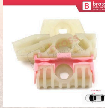
BWR1198 VW Golf MK6 2011-On İçin Ön Sağ Cam Kriko Klipsi RB
