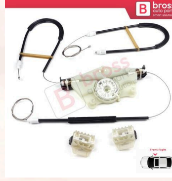
BWR420 Seat Leon MK1 için Sağ Ön Kapı Cam Kriko Tamir Seti 1M0837756
