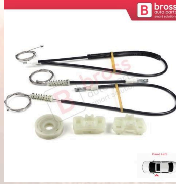
BWR404 Land Rover için Ön Sol Kapı Cam Tamir Takımı LR006371W
