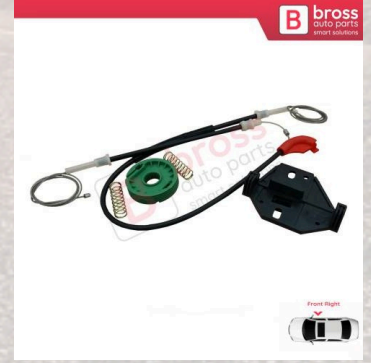
BWR5063 VW T4 Caravelle Eurovan 1990-2003 için Sağ Ön Kapı Cam Kriko Seti 7D0959802
