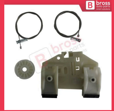
BWR5366 Mercedes Sprinter MK2 VW Crafter MK1 için Ön Sağ Cam Kriko Tamir Seti A9067200146
