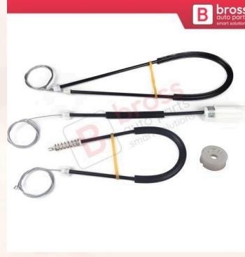
BWR671 VW New Beetle Cabriolet için Sol Ön Kapı Cam Kriko Tamir Seti
