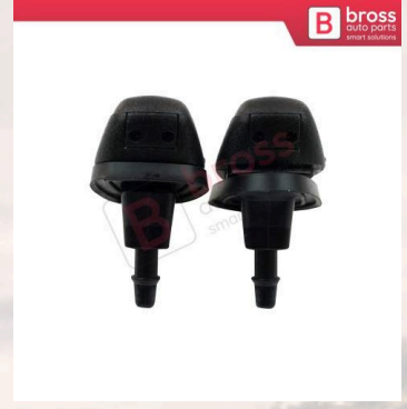
BSP999 Fiat Doblo Fiorino Punto Nemo Bipper için Arka Cam Silecek Su Fiskiyesi 60666173
